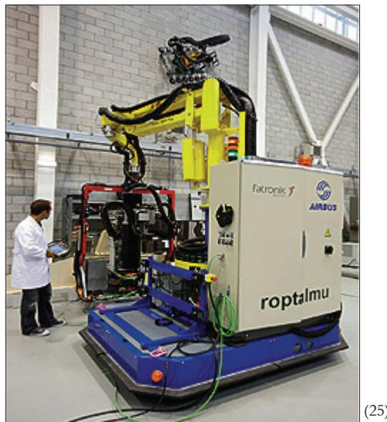
*Le Roptalmu utilisé pour le perçage pour l'installation des grandes pièces composites le long de la queue de l'Airbus A380 et A340.*
