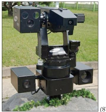
Le SGR-A1 est un drone qui a pour fonction d'être une sentinelle. Posé sur le sol, il guette l'horizon grâce à des capteurs de vision sophistiqués qui détectent une présence que ce soit la journée ou la nuit. Le drone est muni d'une mitrailleuse dont les canons bougent pour suivre sa cible. La mise à feu est peut être commandée manuellement par un militaire sinon lorsque le SGR-A1 est en mode automatique, il la lance lorsqu'il repère un intrus.
